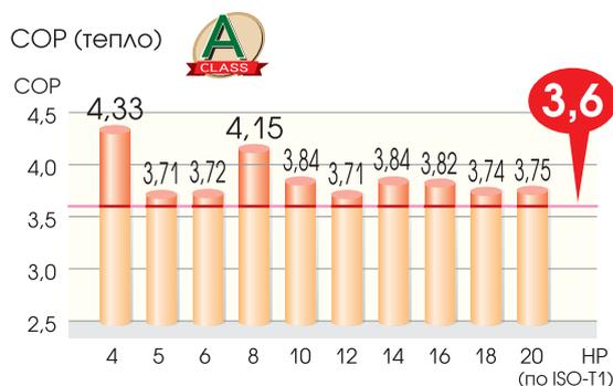
\*COP = Производительность [кВт] / потребляемая мощность [кВт]
