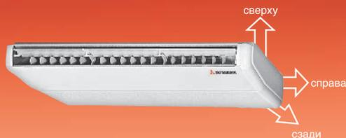
В зависимости от удобства монтажа трубу для подачи хладагента можно подвести с любой из трех сторон: сзади, справа или сверху, а дренажную трубу – слева или справа. Техническое обслуживание производится снизу.
