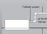
Дренаж можно поднимать на 700 мм от уровня потолка. Это обеспечивает большую свободу при прокладке дренажа. Гибкий шланг длиной 260 мм в качестве стандартного аксессуара упрощает монтаж.
