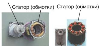
Ротор (из постоянного магнита).
