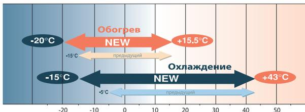
Система KX6 может работать в режиме обогрева при температуре наружного воздуха до  $-20^{\circ}\text{C}$  и в режиме охлаждения до  $-15^{\circ}\text{C}$  ( $-5^{\circ}\text{C}$  у KX4 серии).
