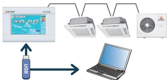
SC-SL3N-BE выдает результаты расчета энергопотребления (в кВт) для каждого внутреннего блока, каждой группы, каждой системы SUPERLINK-II, каждого импульсного счетчика) и использует для сохранения результатов флэш-память и порт USB. Результаты можно редактировать при помощи ПО, поставляемого в комплекте с консолью.
