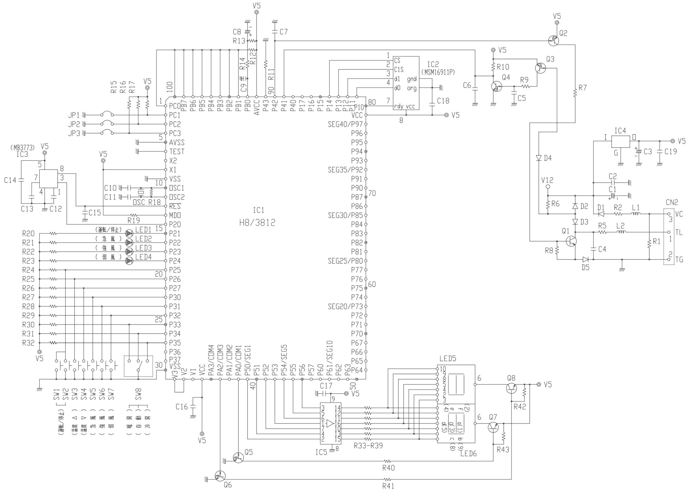
3.11.CIRCUIT DIAGRAM FOR PRINTED CIRCUIT BOARD OF RECEIVER
