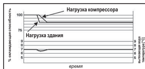
Колебание ELWT (температура воды на выходе испарителя) при бесступенчатом управлении производительностью
