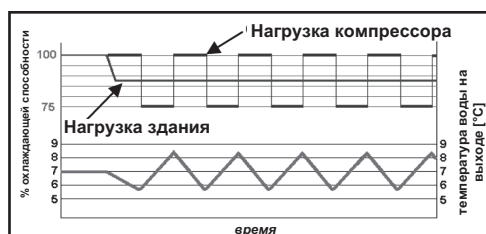
Колебания температуры воды на выходе из испарителя в зависимости от ступени регулирования мощности (4 ступени)
