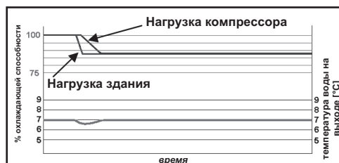
Колебания температуры воды на выходе из испарителя в зависимости от ступени регулирования мощности (4 ступени)
