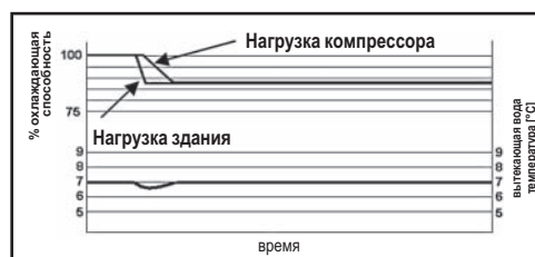
Колебание ELWT (температура воды на выходе испарителя) и бесступенчатое управление производительностью
