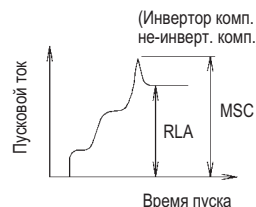
Соотношение между временем пуска и пусковым током
