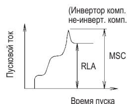
Соотношение между временем пуска и пусковым током
