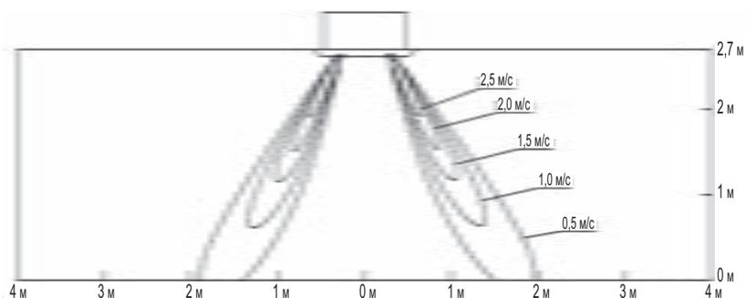
Распределение температуры воздушного потока при нагреве
