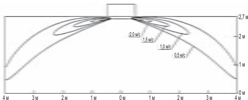
Распределение температуры воздушного потока при охлаждении
