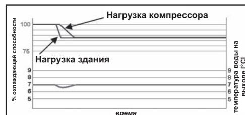
Колебания температуры воды на выходе из испарителя в зависимости от степени регулирования мощности (4 ступени)
