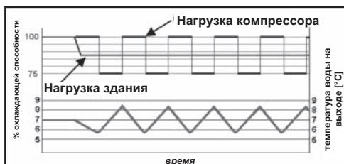
Агрегаты с плавной регулировкой имеют больше преимуществ, чем агрегаты со ступенчатой регулировкой. Способность соответствовать энергопотребностям системы в любое время и возможность обеспечить стабильные температурные показатели воды на выходе без каких-либо отклонений, являются двумя ключевыми моментами, которые позволят вам понять как можно достичь оптимальных рабочих условий системы только при помощи плавной регулировки.
