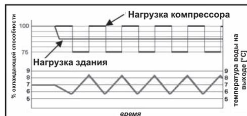
Агрегаты с плавной регулировкой имеют больше преимуществ, чем агрегаты со ступенчатой регулировкой. Способность соответствовать энергопотребностям системы в любое время и возможность обеспечить стабильные температурные показатели воды на выходе без каких-либо отклонений, являются двумя ключевыми моментами, которые позволяют вам понять как можно достичь оптимальных рабочих условий системы только при помощи плавной регулировки.
