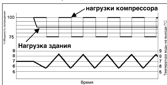
Неустойчивость EWLТ с шаговым регулированием производительности (4 ступени)
