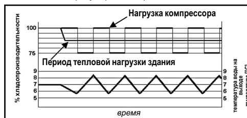
Колебания температуры воды на выходе из испарителя в зависимости от ступени регулирования мощности (4 ступени)
