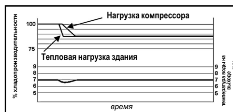
Колебания температуры воды на выходе из испарителя с плавной регулировкой производительности
