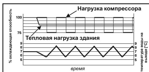
Изменение ELWT (температура воды на выходе испарителя) в зависимости от выбранного значения производительности (4 значения)
