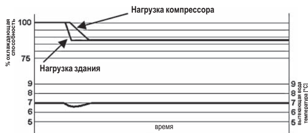
Колебание ELWT (температура воды на выходе испарителя) при ступенчатом управлении производительностью
