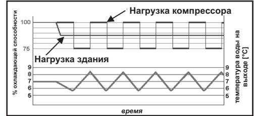
Агрегаты с плавной регулировкой имеют больше преимуществ, чем агрегаты со ступенчатой регулировкой. Способность соответствовать энергопотребностям системы в любое время и возможность обеспечить стабильные температурные показатели воды на выходе без каких-либо отклонений, являются двумя ключевыми моментами, которые позволят вам понять как можно достичь оптимальных рабочих условий системы только при помощи плавной регулировки.
