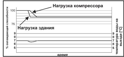
Колебания температуры воды на выходе из испарителя в зависимости от ступени регулирования мощности (4 ступени)
