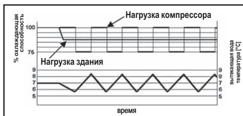
Колебание ELWT (температура воды на выходе испарителя) и ступенчатое управление производительностью (4 значения)
