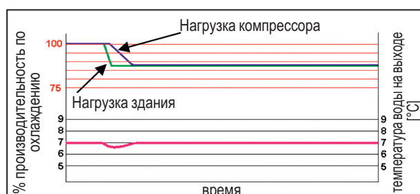
Изменение ELWT (температура воды на выходе испарителя) при бесступенчатом управлении производительностью
