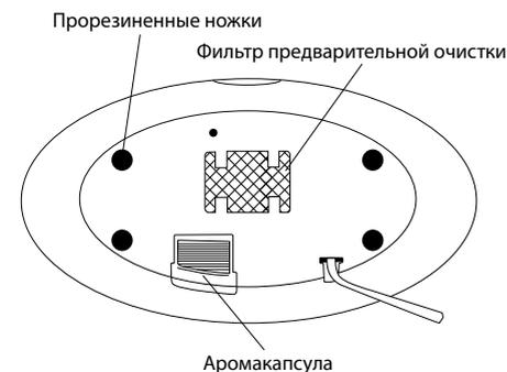
Рис.3 База прибора (основание)
