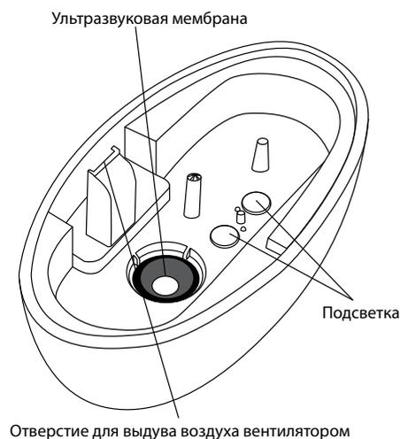
Рис.2 База прибора
