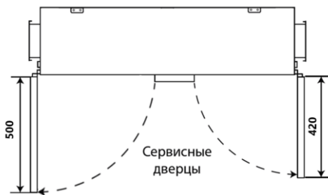
Рис. 6. Сервисное пространство снизу
