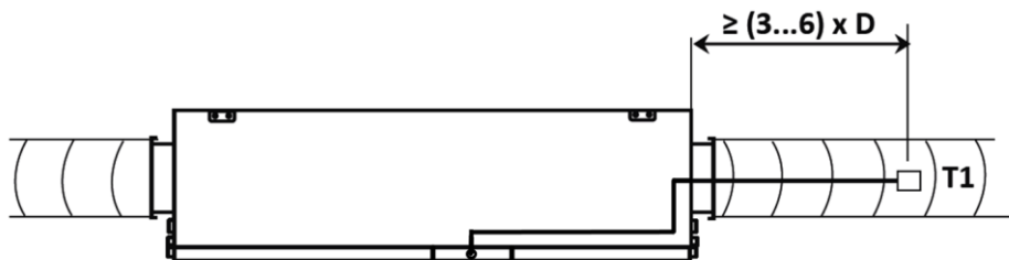
Рис. 12. Установка датчика температуры приточного воздуха
