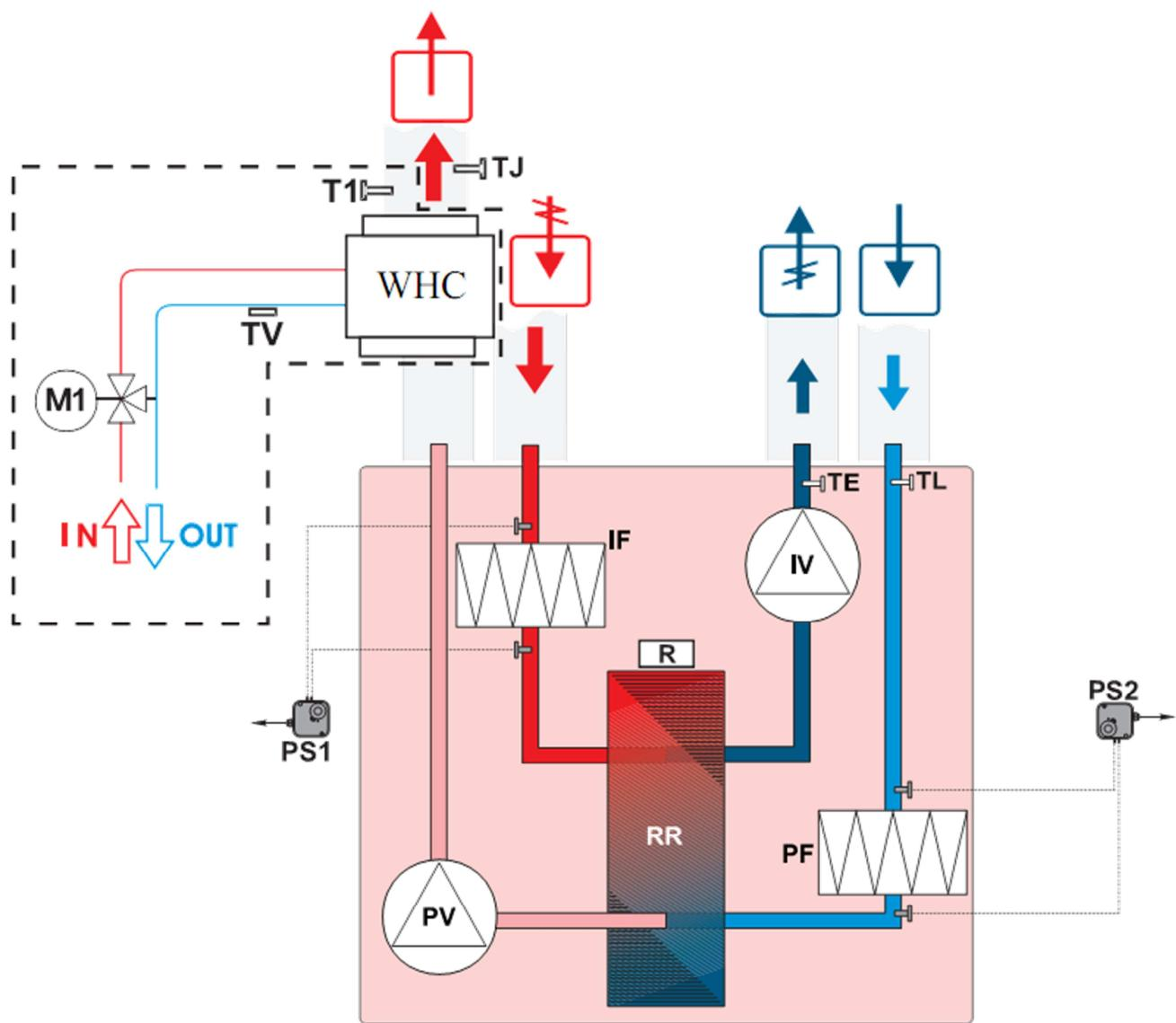
PV – вентилятор приточного воздуха;
