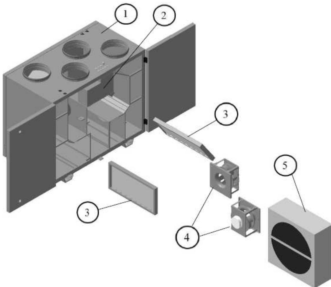
1 – Корпус, 2 – Панель автоматики, 3 – Фильтр, 4 – Вентилятор,
