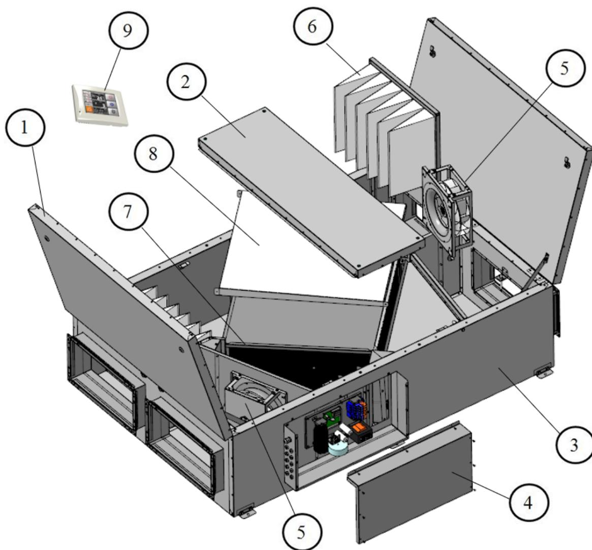
1 – Дверь навесная; 2 – Вставка; 3 – Корпус; 4 – Крышка блока управления; 5 – Вентилятор; 6 – Фильтр; 7 – Рекуператор; 8 – Поддон; 9 – Пульт управления.
