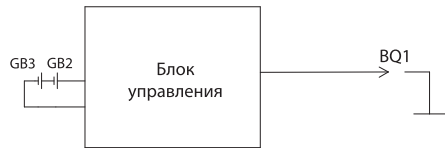
Цепь зажигания BOGH-15
