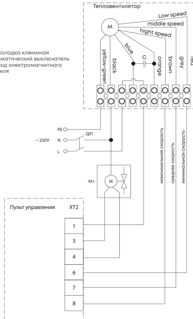
Подключение водяного тепловентилятора к термостату BMC-2
