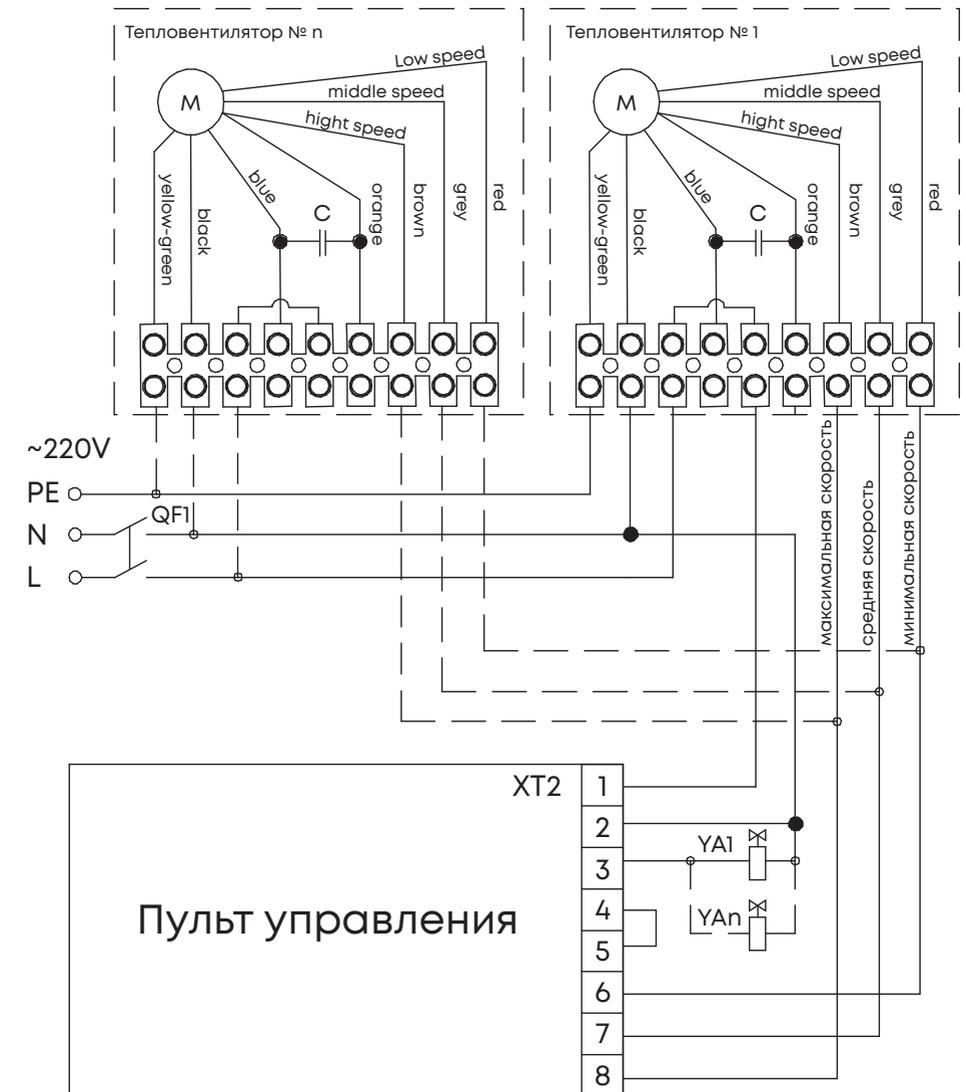
При подключении по схемам указанным выше (стр. 20-21) регулировка температуры помещения осуществляется при помощи открытия/закрытия электромагнитного клапана (без выключения функции вентилляции).
