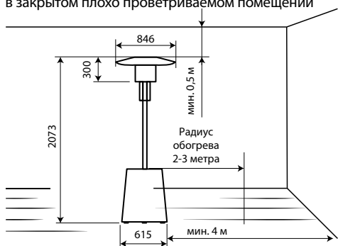
Рис. 1в – Размеры прибора и допуски (0,5 min)
